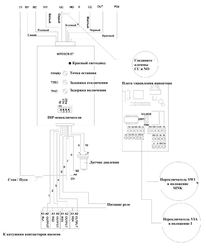
Катушки промежуточных реле могут быть на любое напряжение: 24В, 110В, 220В постоянного или переменного тока.
