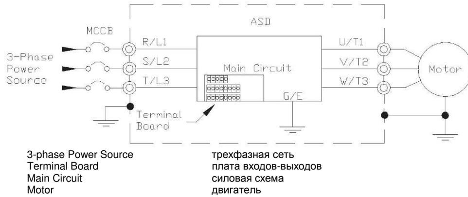
Подключите трехфазную сеть ко входным зажимам преобразователя **R/L1**, **S/L2** и **T/L3**. Подключите выход преобразователя (зажимы **U/T1**, **V/T2** и **W/T3**) к двигателю. Используемые кабельные наконечники должны соответствовать требованиям, приведенным в разделе «Исполнения: напряжение/ток».
