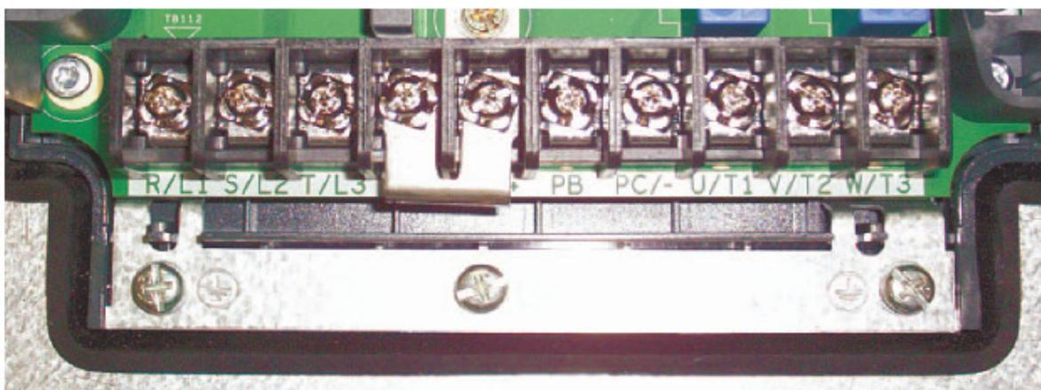
Зажимы **U/T1, V/T2 и W/T3** являются выходом преобразователя и предназначены для подключения двигателя.
