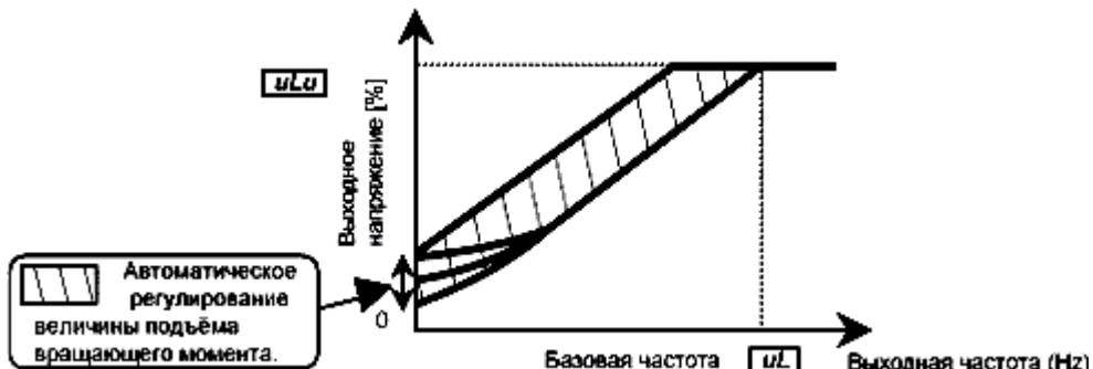
Примечание. При этой системе управления могут возникнуть колебаниям и дестабилизация работы в зависимости от типа нагрузки двигателя. Если это происходит, задайте значение параметра  $Pt = 0$  и увеличьте момент с помощью ручной настройки.
