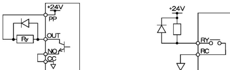
[Диаграмма подключения терминала с открытым коллектором OUT] [При использовании реле]
