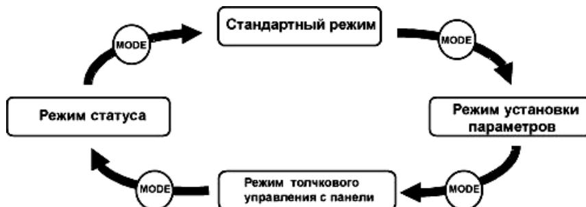
Примечание: Когда инвертор работает (индикатор RUN мигает) или когда дана команда к работе (индикатор RUN горит), инвертор не может быть переведён в режим использования толчкового управления двигателем с панели.
