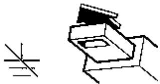
← Для отключения конденсатора от заземления, вытяните этот выключатель
