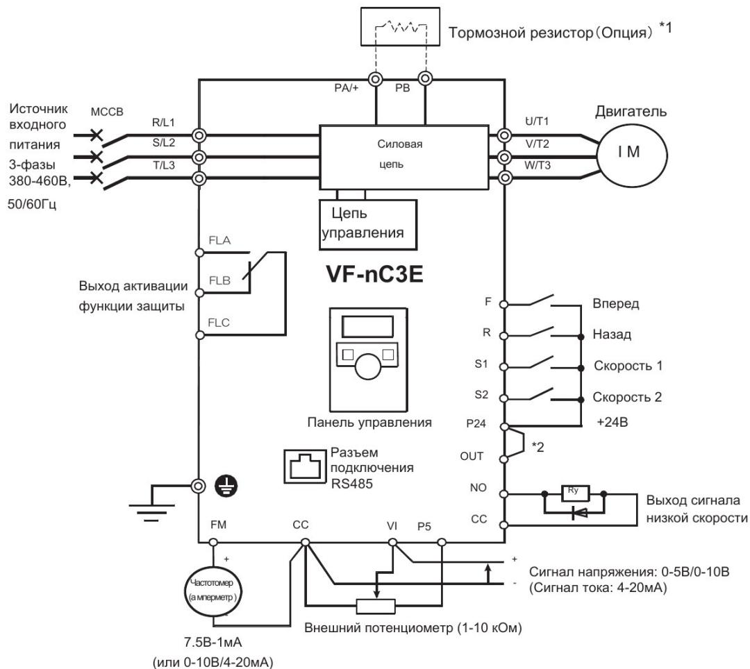
Клеммы силовой цепи. Подключение optionalных устройств.
