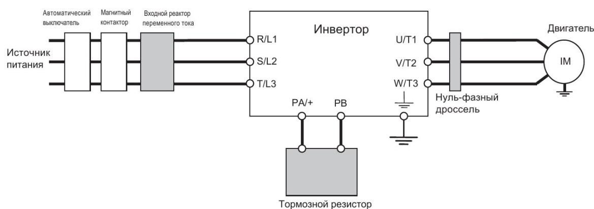
Примечание 1: Терминалы PA/+ и PB отсутствуют в VFNC3E-4007P.
